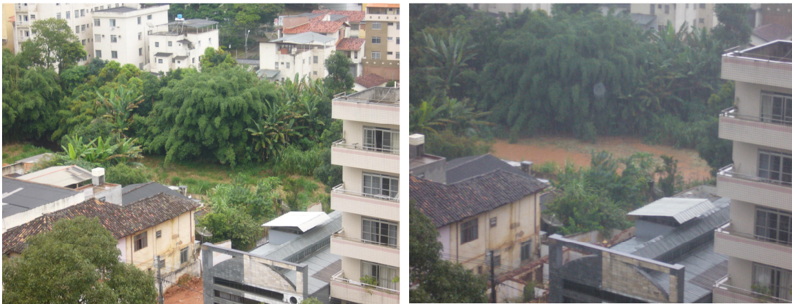
FIGURA 51 – Vista parcial da área de alagamento localizada atrás da padaria “Vesúvio” (A); área inundada (B) provocada pela secção de estrangulamento da galeria que passa sob Avenida Bueno Brandão
