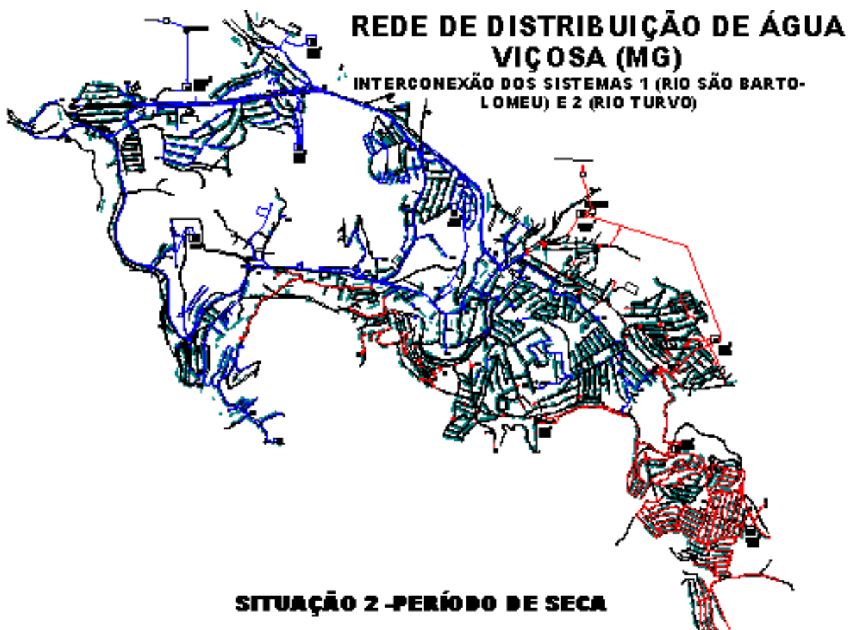
FIGURA 9 – Interconexão dos sistemas de abastecimento de água de Viçosa durante a estiagem.
