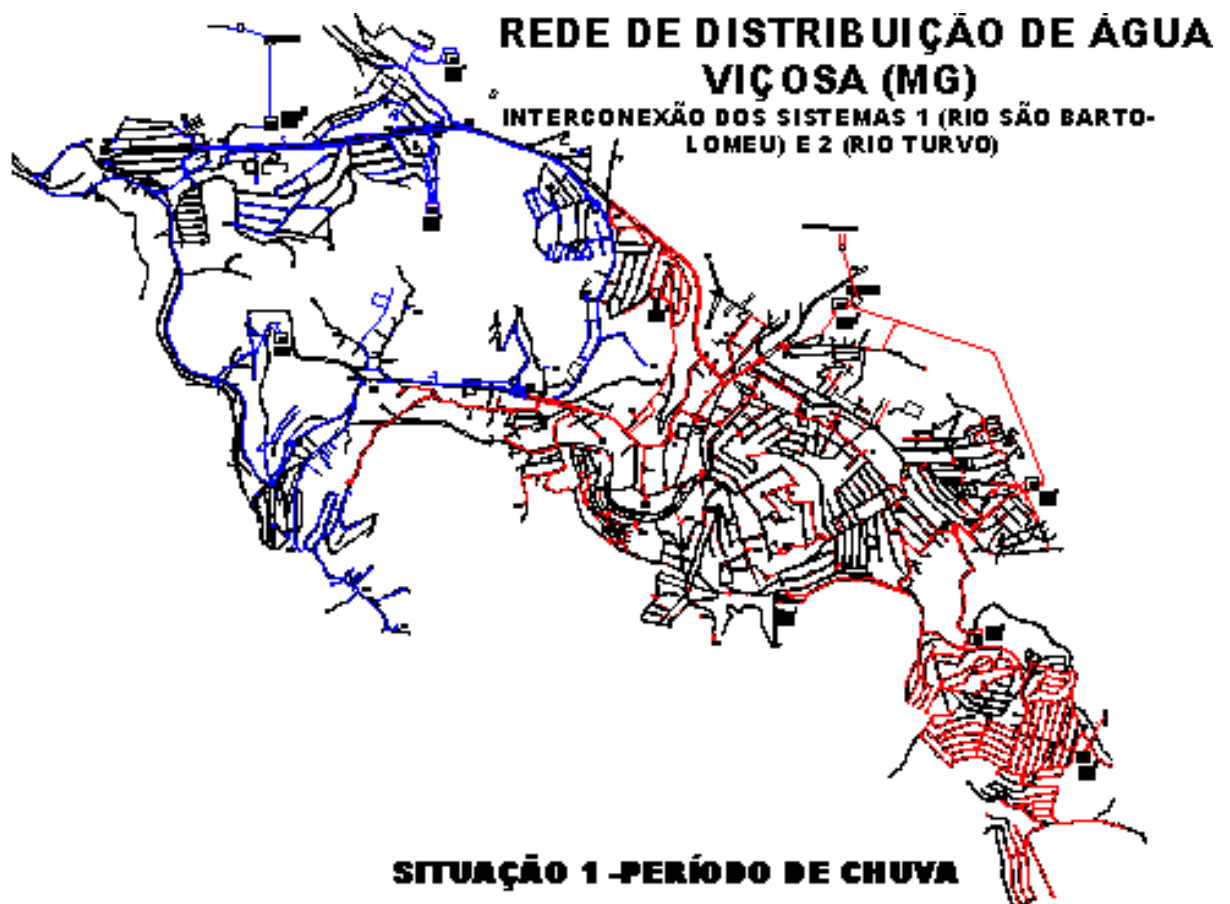
FIGURA 8 – Interconexão dos sistemas de abastecimento de água de Viçosa durante período de chuva.
