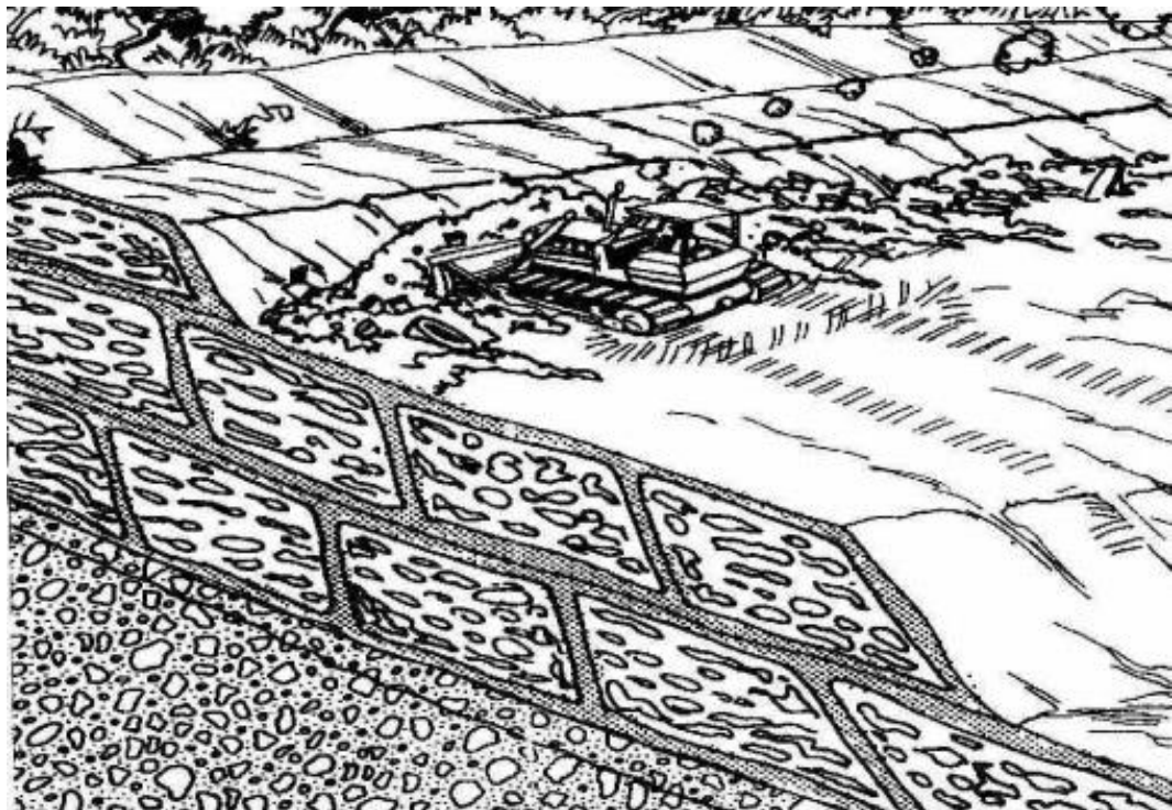
Figura 8 – Células diárias de cobertura de resíduo.
